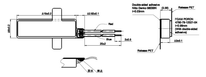
默认的连接形式为20mm长AWG32导线(剥头2mm),可根据客户要求换成连接器、电极弹簧等 其它连接形式。
